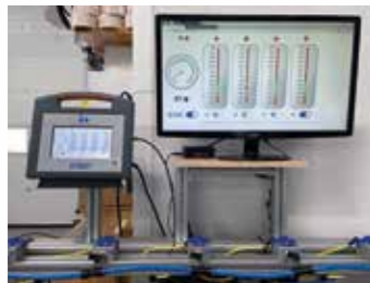
CARRYTEC Gehäusesystem mit besonders großem User-Interface und viel Schnittstellenfläche. Sockel (Zubehör) als Ablage-/Halterung nutzbar.
