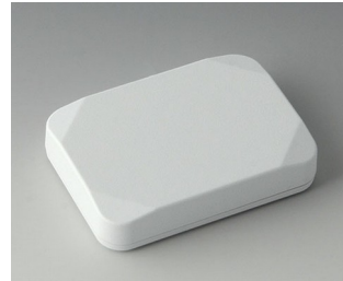
B1824117 MINI-DATA-BOX E50, flach ASA+PC (UL 94 V-0) verkehrsweiß RAL 9016 70x50x15mm IP 65 opt., IP 40
