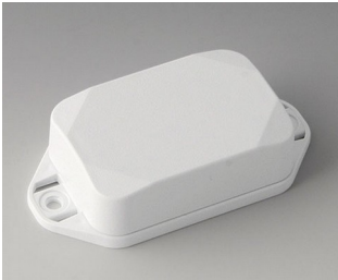
B1822227 MINI-DATA-BOX EF40, hoch, mit Flansch ASA+PC (UL 94 V-0) verkehrsweiß RAL 9016 60x40x20mm IP 65 opt., IP 40
