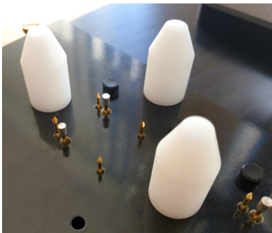
Bild 6: 1000 \text{ A} Puls über eine Nadel pro Kontakt.
