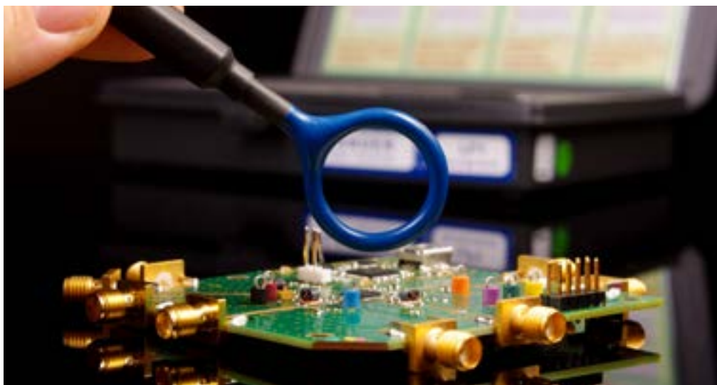
EMV-Tests zur Erkennung elektromagnetischer Emissionen, die von einer Leiterplatte ausgehen.
