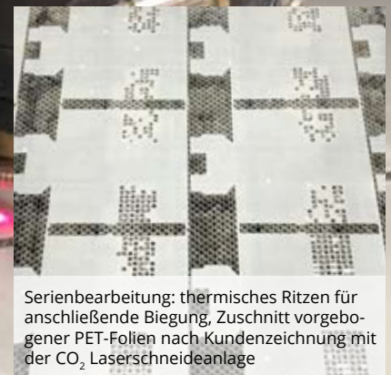
Laserzuschnitt und Gravur einer 2-farbigen Bedienfolie
