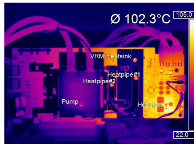
Wärmebild eines in Betrieb befindlichen Motherboards Quelle: www.igorlab.de (Igor Wallossek)
