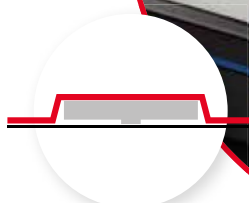
Profiline-Prägung Höhe ca. 1,0 - 1,5 mm*
