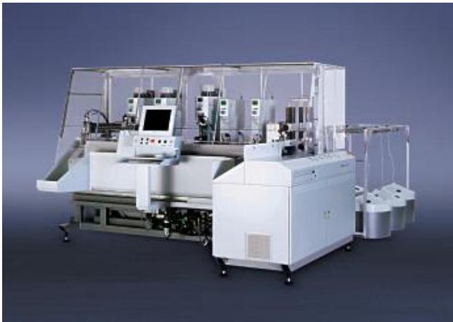
Integration des STOCKOMATEN ECO-TRONIC professional line in den Crimpautomaten Komax Zeta 633, zur vollautomatische Fertigung von einseitig IDC-bestückten Kabelbäumen
